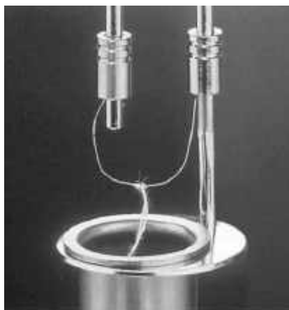
Abbildung 3: Zünddraht und -faden
